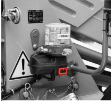
Att. 195: Centrālās eļļošanas sistēmas novietojums transportlīdzeklī
