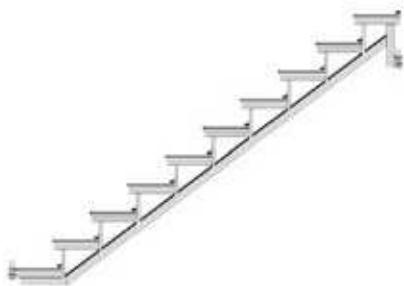
U-trepi külg 200, 10 astet, viitenr. 2638.010, 2,0 x 2,57 m
