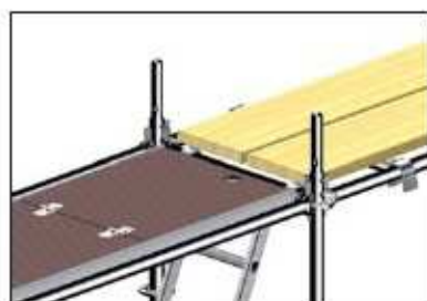
Joon. 51: Läbikäigupõrand Tugilatt – Ajutised lauad
