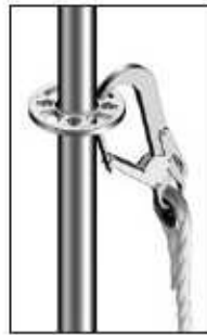
Joon. 28: Võimalik on ühendus roseti väiksesse või suurde auku (kehtib ainult Allround terastellingu, mitte alumiiniumi puhul)
