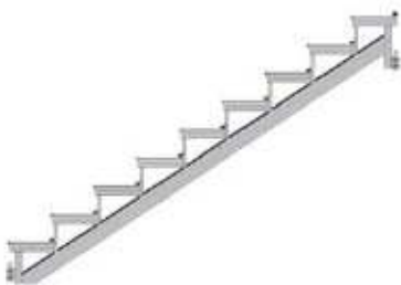
U-trepi külg 500, 9 astet, viitenr. 2638.009, 2,0 x 2,57 m
