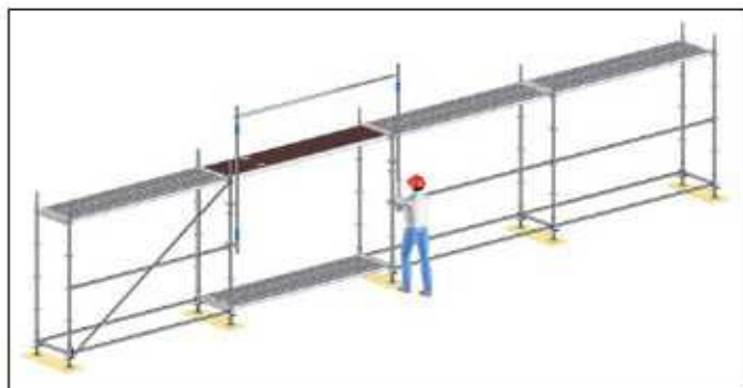
Joon. 35: Eelneva kaitsepiirde paigaldamine läbikäigumooduli puhul
