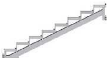
U-trepi külg 750, 8 astet, viitenr. 2638.008, 1,5 x 2,57 m
