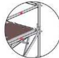
Joon. 87: Vertikaalsete standardite ühendamine lukustustihvtiga.
