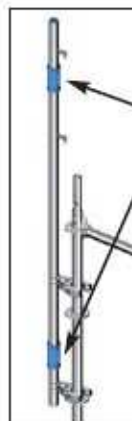
Joon. 34: Eelneva kaitsepiirde posti kinnitamine vertikaalse standardi külge
