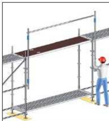
Joon. 35: Eelneva kaitsepiirde paigaldamine läbikäigumooduli puhul
