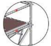
Joon. 88: Vertikaalsete standardite ühendamine sissekeeratava tapiga
